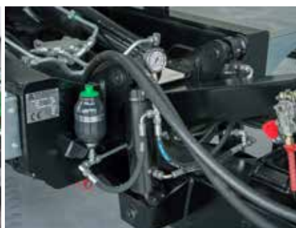
Höhenverstellbare, hydraulisch gefederte Deichsel, zur Optimierung des Fahrkomforts und Erleichterung des Ankuppelns
