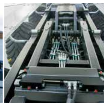
Stabile Rahmenkonstruktion und hydraulische Containerverriegelung garantieren die Sicherheit während der Fahrt
