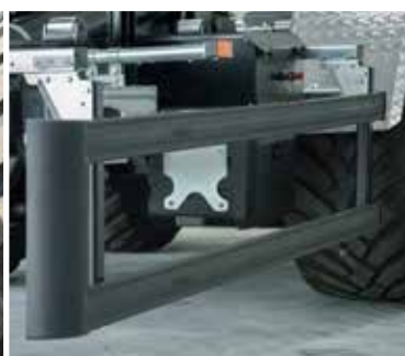
Sicherheitsoptimierung mittels seitlichem Unterfahrerschutz
