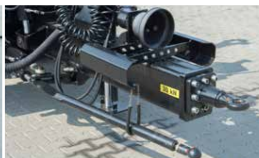
Zwanglenkung (in Fahrrichtung rechts) zur erleichterten Manövrierung
