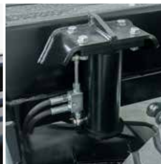
Hinterachsabstützung zur Absicherung während der Verladung
