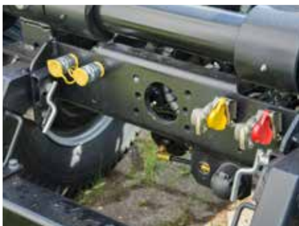
Nützliche Zusatzausstattung: Hintere Brems- und Hydraulikan schlüsse
