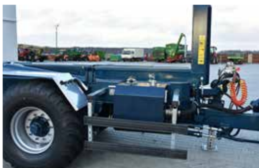
Eigene Ölversorgung mit effizienter Pumpe trägt zu größerer Zylinderkraft bei und beschleunigt die Arbeit
