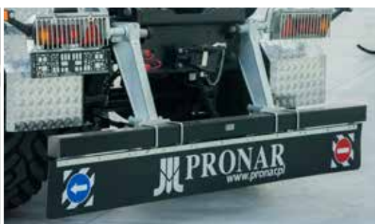
Spritzschutz hinten über die gesamte Breite
