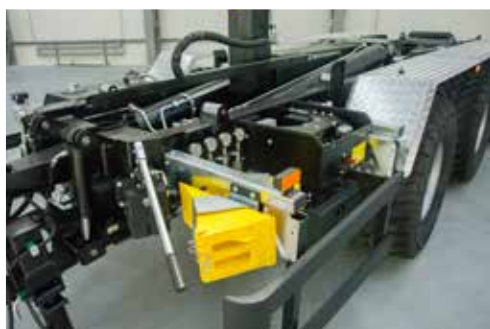
Steuerung des Zwanglenkungssystems
