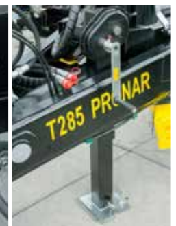
Teleskopstützfuß mit Getriebe
