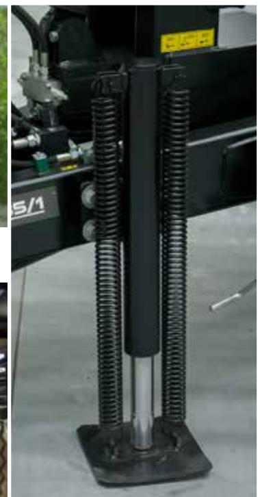
Hydraulischer Stützfuß mit Kugelventil
