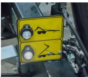
Hydraulische Umschaltung der Funktionen: Haken/Kippen beim T185/1, erleichtert die Bedienung
