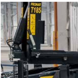
Mechanische Einstellung der Funktionen: Haken/Kippen beim T185
