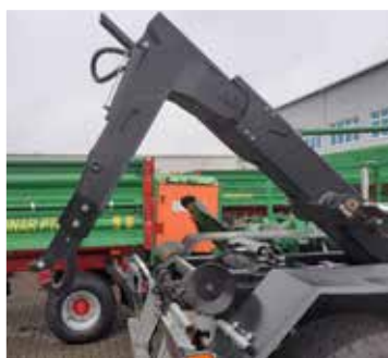
Schub- und Knickarm zur Abflachung des Aufzugswinkels
