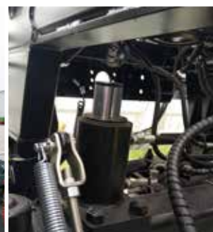
Hinterachsabstützung zur Stabilisierung des Anhängers während der Verladung des Containers
