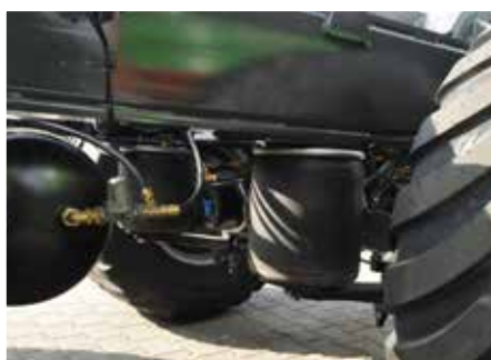
Pneumatische Aufhängung zur kontinuierlichen und fließenden Stoßdämpfung des Anhängers während der Fahrt
