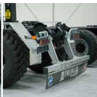
Hydraulisch erleichterte Bedienung des ausziehbaren Unterfahrerschutzes
