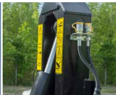
Nützliche Zusatzausstattung: Hydraulikanschlüsse auf dem Haken
