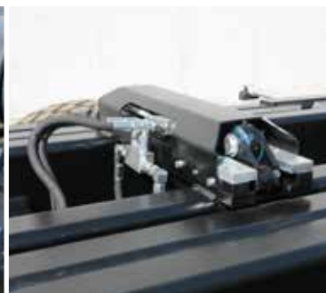
Hydraulische Containerverriegelung zur optimalen Sicherung des Containers
