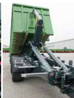
Problemlose Entladung und Aufziehung des Containers dank der zwei Kippzylinder
