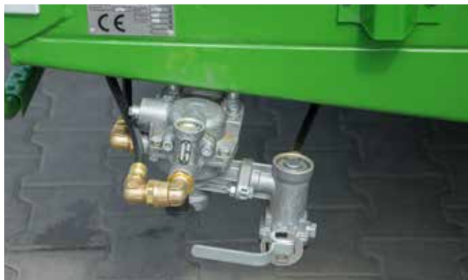
Manuelle Bremskraftregelung entsprechend des Transportgewichts in der Standardausführung
