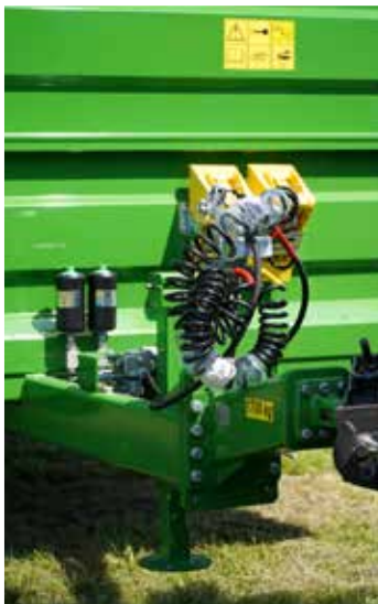
Mechanischer Stützfuß mit Kurbel in der Standardausstattung enthalten
