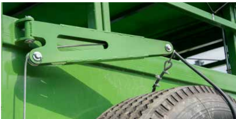
Manuelle Reserveradwinde an der Vorderwand (Option)
