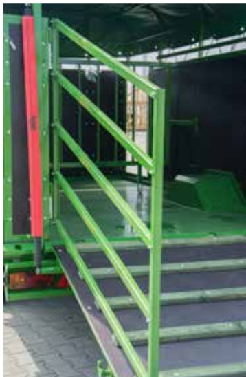
Seitliche Fanggitter sichert entspannte Tierentladung
