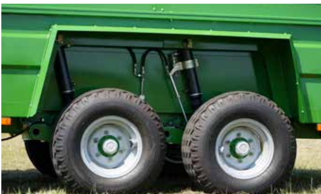
Hydraulische Dämpfung, sowie Halbachsen zur Erhöhung des Fahrkomforts für die Tiere
