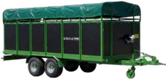
Bordwände aus wasserresistentem Sperrholz
