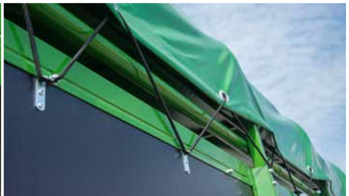
Schnürplane für eine komfortable Fahrt für die Tiere bei allen Wetterverhältnissen
