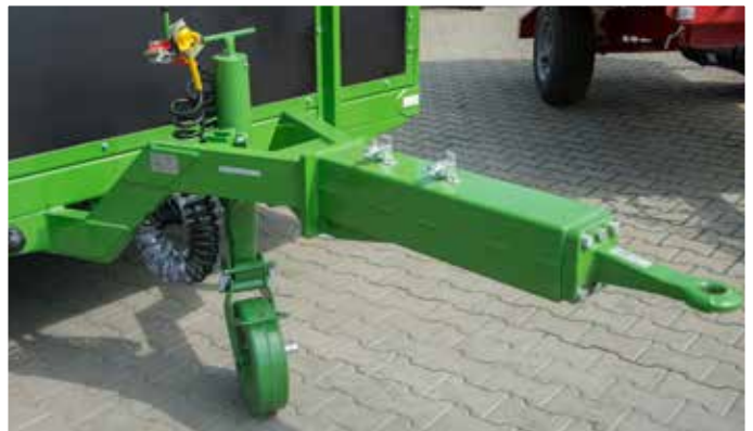
Universal-Deichsel zur Unten- und Obenanhängung mit starrer Zugöse Ø40
