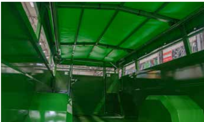
Brückenmaß innen: Länge 6290 mm, Breite 2240 mm, Höhe 2100 mm
