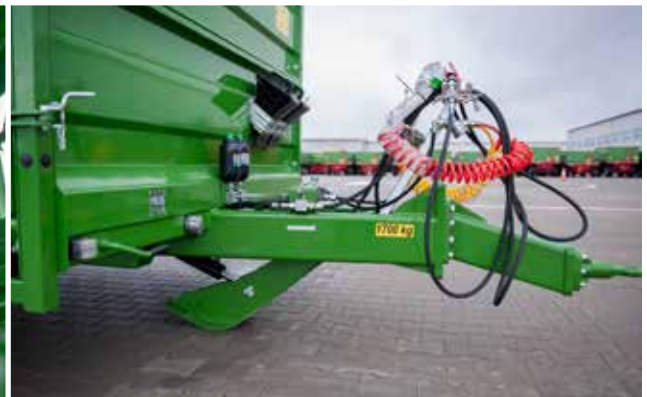
Zeit- und kraftschonender hydraulischer Schrägstützfuß mit Kugelventil (Option)
