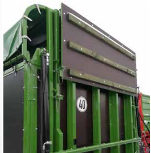
Verlängerte Heckklappe, hydraulisch (Option) zur Abflachung des Abstiegswinkels
