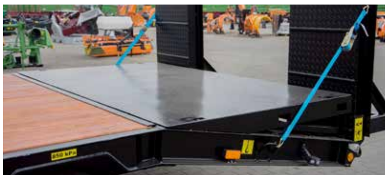
Heckanschragung mittels Keilplatte (Option) zur Erweiterung der Nutzfläche bei RC2100/2, RC3100 und RC3100/1
