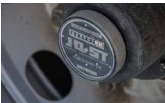
Optionaler Kilometerzähler zur einfachen Bestimmung von Wartungsintervallen und Reifenchecks
