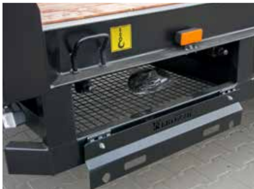
Stahlkorb zur Aufbewahrung der Holzbretter für die Bodenverbreiterung
