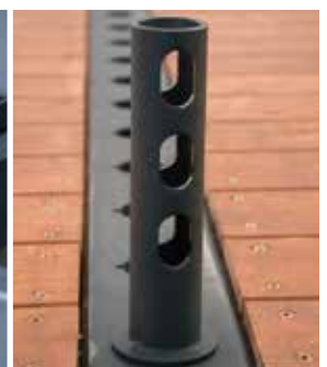
Begrenzungsringen zur Stabilisierung länglichen Ladegutes (z.B. Stahlprofile)
