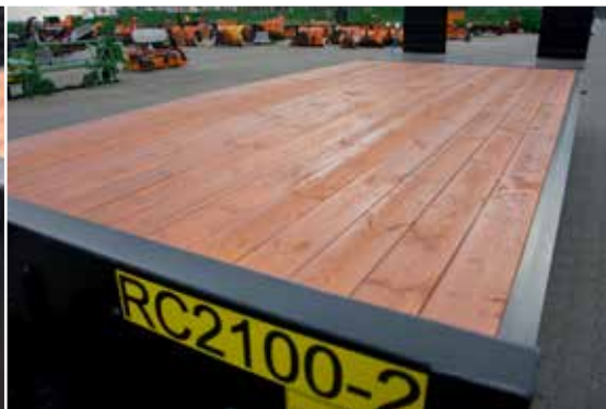
Plattfornboden aus Nadelholz (45 mm) zur Reduktion des Gesamtgewichts und Erhöhung des Ladevolumens
