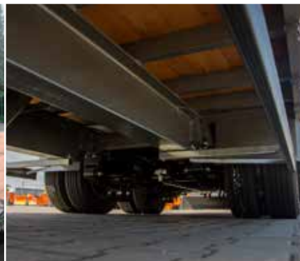
Fahrwerk mit Unterfahrschutz
