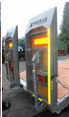
Auffahrrampen mit Reflektoren
