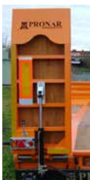
Hydraulische Auffahrrampen (Standard bei PB3100, Option bei PC2300)
