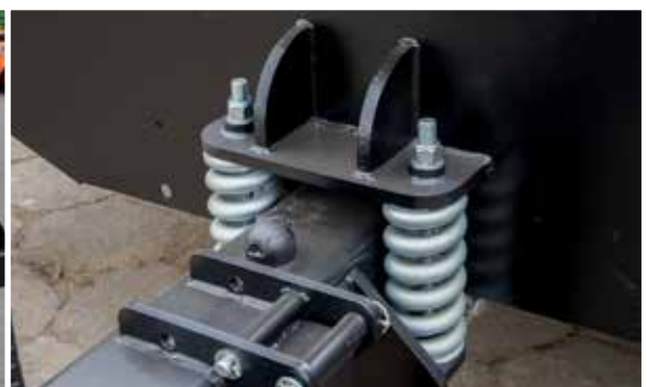
Gefederte Deichsel erhöht den Fahrkomfort
