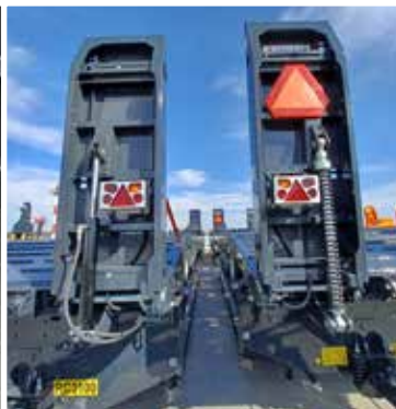
Wahlweise mechanisch o. hydraulisch gesteuerte Auffahrampen bei RC2100/2, RC3100 und RC3100/1
